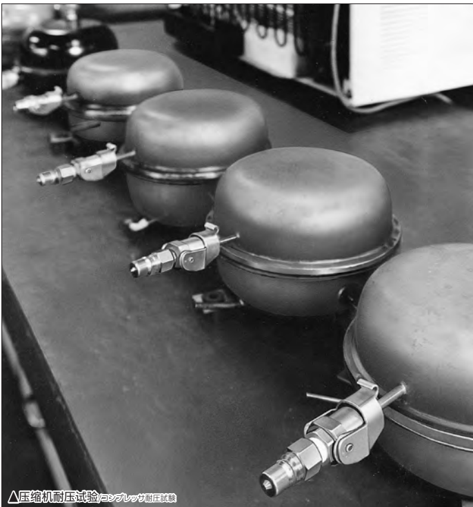
△压缩机耐压试验/コンプレッサ耐圧試験
