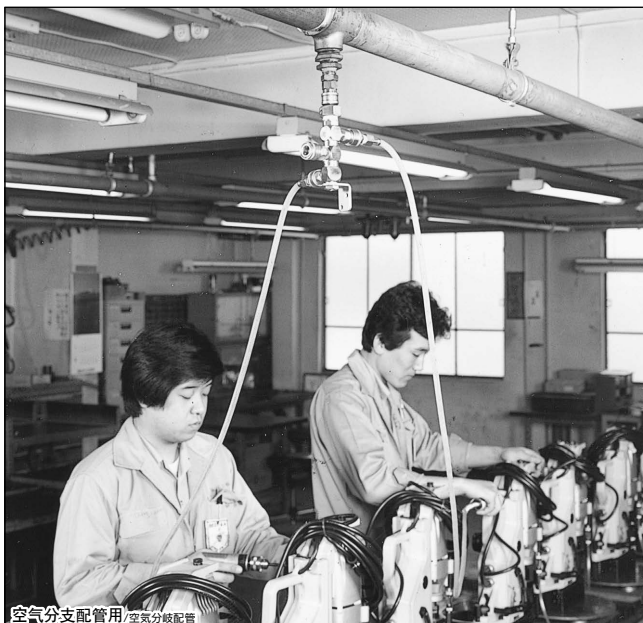
空气支配管用/空気分岐配管
